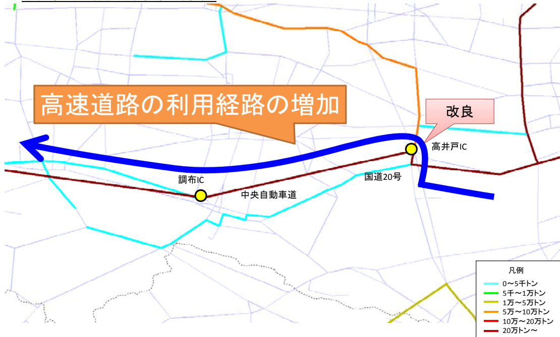
図4.5.6 中央高速道路高井戸ICの折進障害の影響
