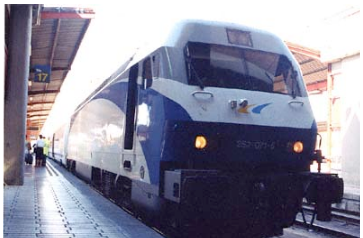
スペインの異軌道間走行車両「タルゴ」。しかし動力車ではない。
