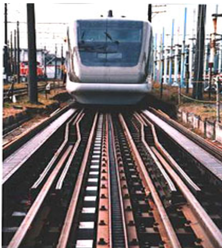
日本で実験中の標準軌－狭軌連続走行可能な車両
