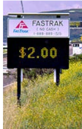
写真-5.2 料金可変表示板
