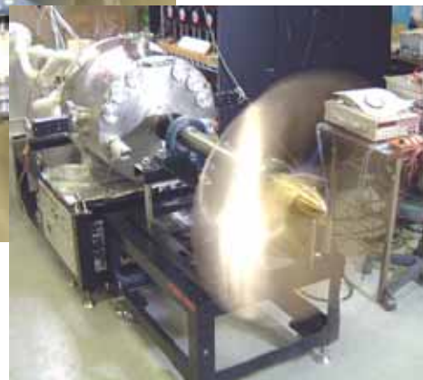
平成17年 複層界磁型 (設計は3層界磁型で複層界磁を実装して回転)
