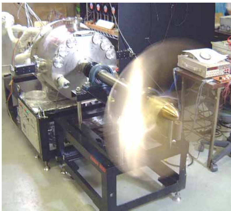
図2 複層界磁型バルク高温超電導モータ回転試験写真 (回転界磁が2層で16個のバルク磁石を実装している)
