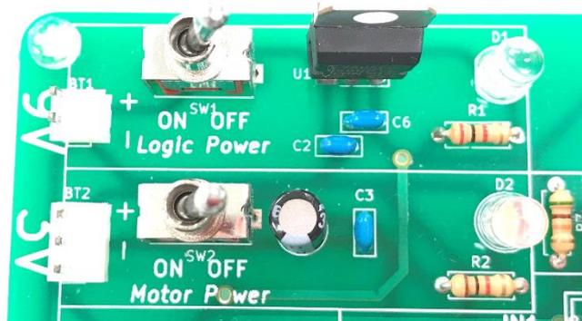
図 2-3 電源回路部分
