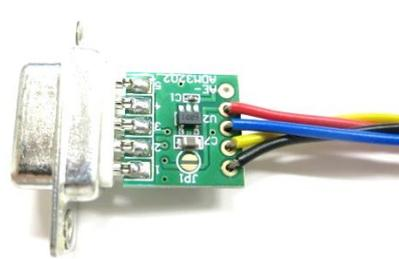
図 5-3 RS232C レベル変換基板
