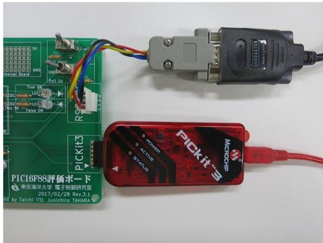
図 5-4 RS232C レベル変換モジュール接続時
