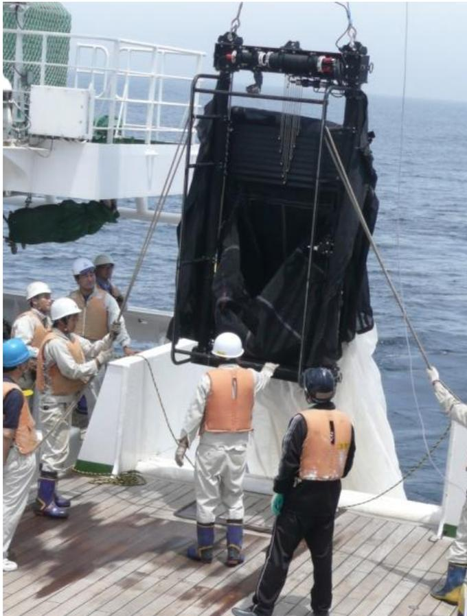
写真9 IONESSを船尾から海に入れているところ。プランクトンネットが9枚ついています。この開閉は研究室のコンピュータで遠隔操作します(写真10参照)。
