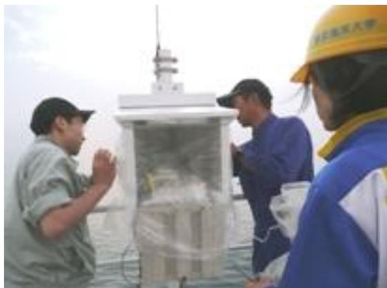
写真29 百葉箱に空間線量計を設置。ここでGPSロガーで位置を、また、ガンマ線計測器で放射能を記録します。
