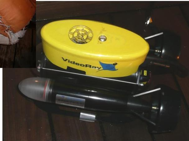
写真35 ビデオカメラと照明を搭載した、遠隔無人探査機。
