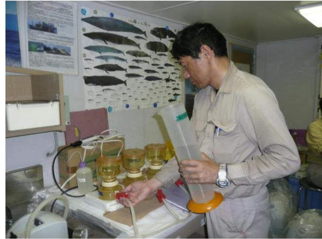
写真38 水深別に採取した海水をろ過する準備をする、荒川久幸さん。専門は水の濁りと光。
