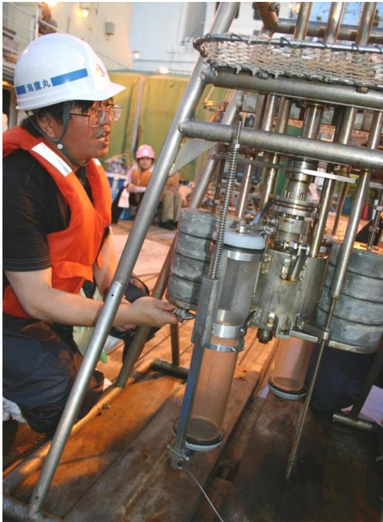
写真16 ミニマルティプルコアラーは円柱状に海底から泥を採取するための装置です。神田穰太さんは化学海洋学が専門。
