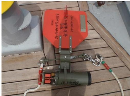
写真2 流速計（提供：溝端浩平さん）。
