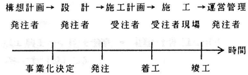
図一 土木工事の流れと段階区分
