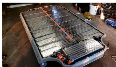
図3 テスラモデルSの床下蓄電池
