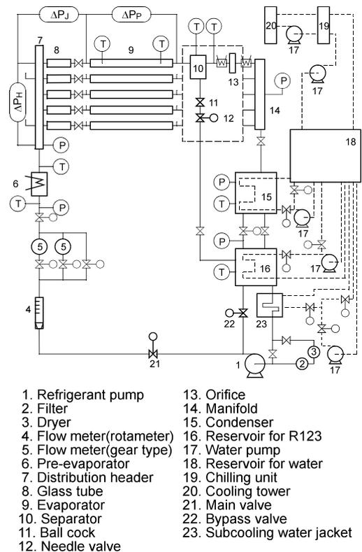
Fig. 1 Experimental apparatus
